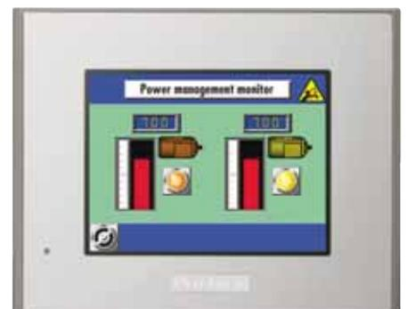
Bei ARAmatic setzt man auf ein 3,8 Zoll kleines Pro-face Panels mit einem schnellen 64-Bit RISC Prozessor und Echtzeitbetriebssystem aus der Serie AGP 3000 mit Ethernet-Schnittstelle. Darauf läuft die Projektierungs- und Visualisierungssoftware GP-Pro EX.
